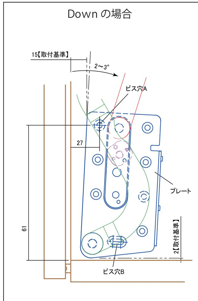
**取付のポイント** 閉じた時の扉上部がしっかりとキャビネット側に吸い付くようにするため、まずはビス穴Aとビス穴Bだけを取付け、図のようにビス穴Aを支点にプレートがあらかじめ(2°～3°)傾いて取付くようビス穴B側で調整し、その後すべてのビスを取り付けて固定します。
